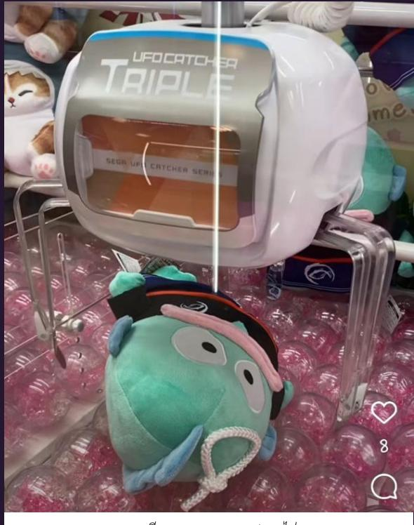
Figure 5 ขาดีบแบบ UFO Catcher ไม่สามารถหมุนหรือแกะร้าดี จะเคลื่อนที่ขึ้นลงเท่านั้น
