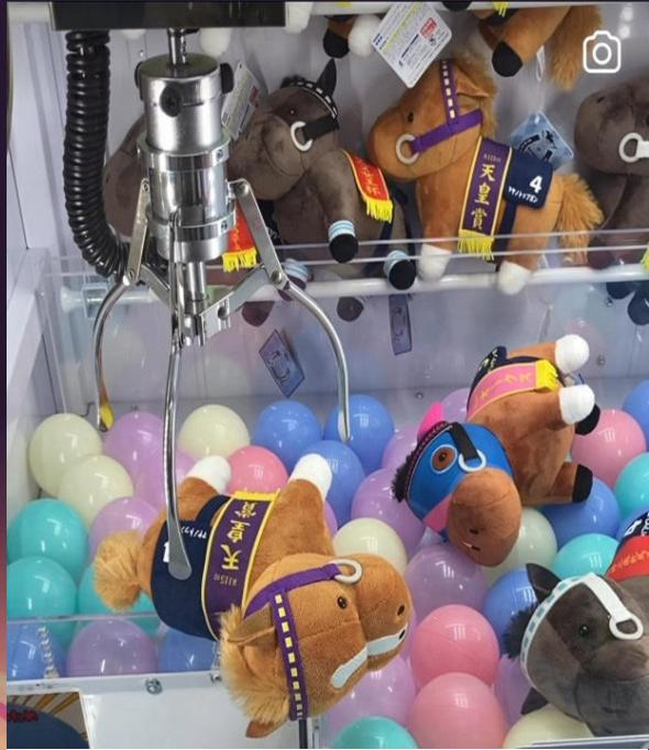
Figure 6 ขาดีบแบบ Claw machine ขณะเคลื่อนที่ลง สามารถหมุน หรือ แกะง้อได้
