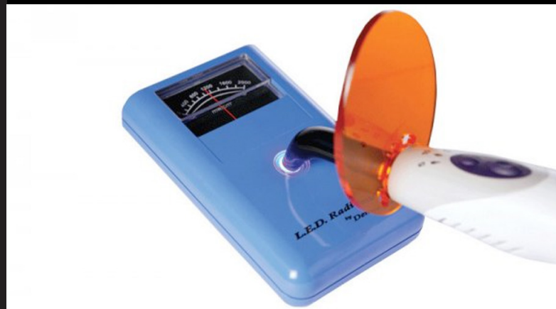
รูปแสดงการวัดค่าความเข้มแสงด้วยเครื่อง Radiometer
