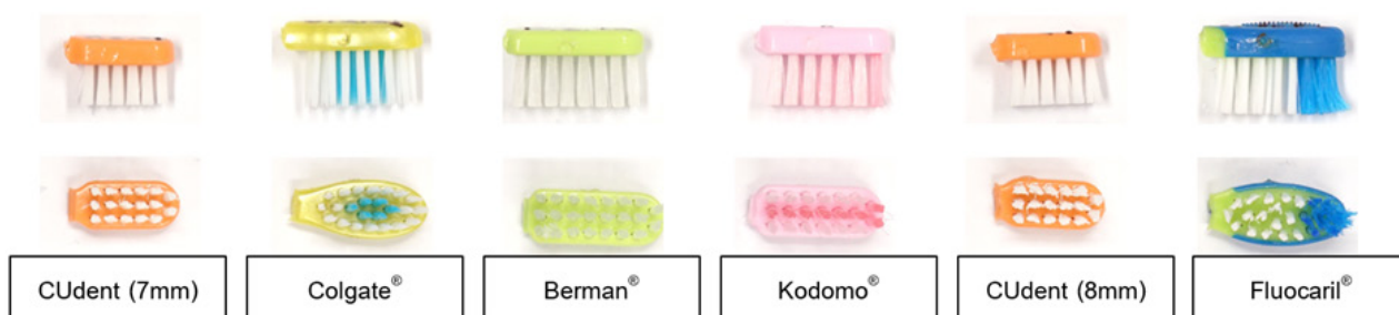
รูปที่ 5 ขนแปรงหลังการทดสอบด้วยการแปรงฟัน 100,000 รอบ
