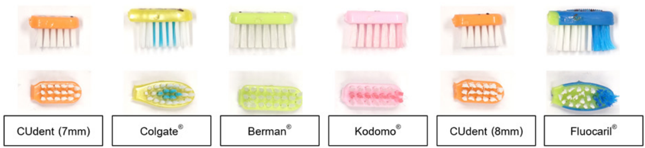
รูปที่ 5 ขนแปรงหลังการทดสอบด้วยการแปรงฟัน 100,000 รอบ
