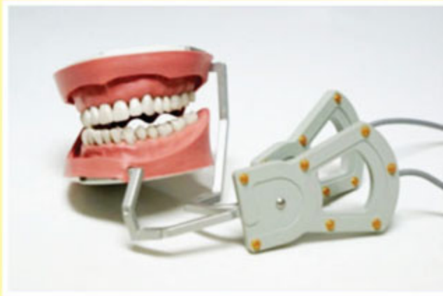
รูปที่ 4 แสดงแบบจำลองบนและล่างที่มี tracking Light Emitting Diodes (LEDs)
