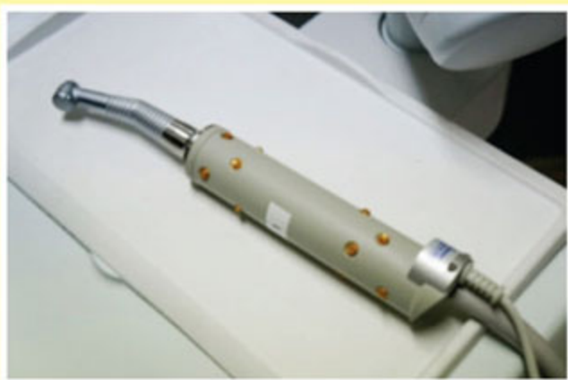
รูปที่ 5 แสดงด้ามกรอฟันที่มี tracking LEDs
